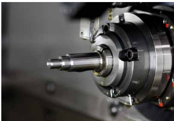
Präzision im Griff: Blick auf die Hauptspindel der TNL 18P, die aktuell ein Wellenwerkstück spannt. Im Bild rechts das fertig bearbeitete Wellenstück.
